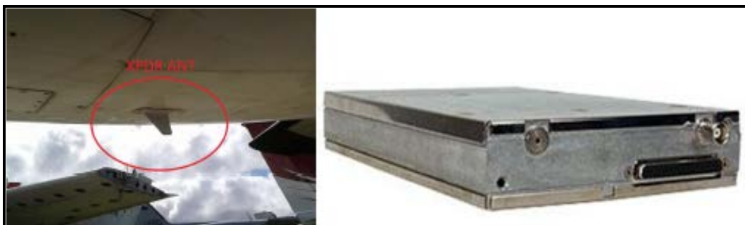
Figura 37. Garmin GTX 32 con su antena correspondiente
