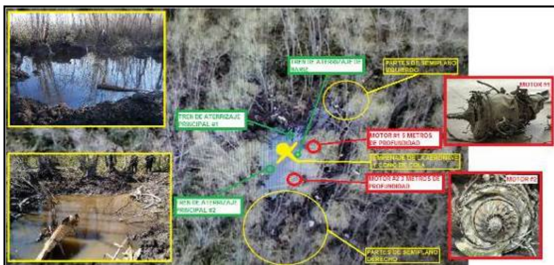
Figura 14. Dispersión de restos y/o componentes de la aeronave
