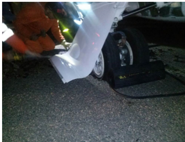
Figura 3. Tren principal izquierdo hundido en la superficie de asfalto
