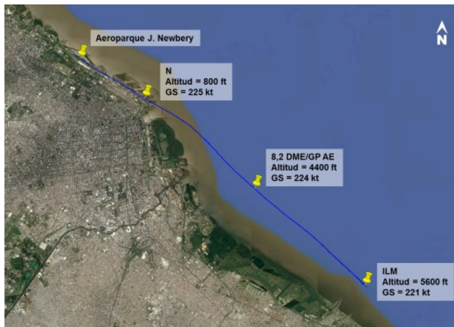
Figura 7. Trayectoria de la aeronave durante aproximación
