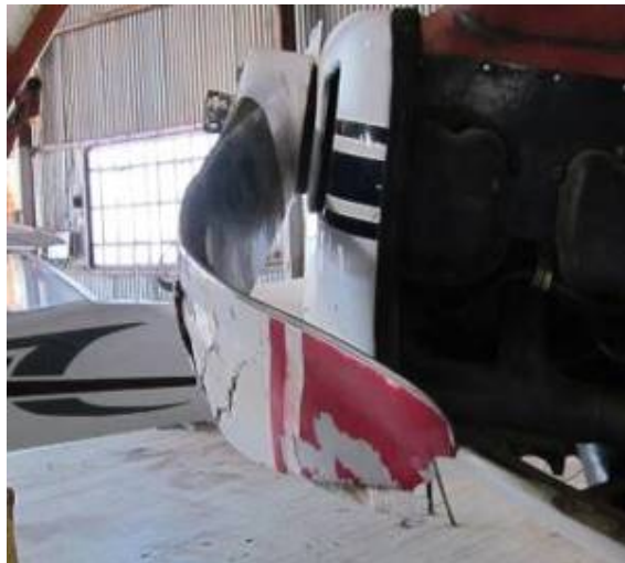
Figura 8 y 9. Vista general de la hélice con los daños en ambas palas
