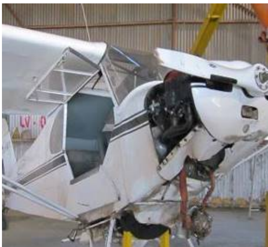
Figura 8 y 9. Vista general de la hélice con los daños en ambas palas
