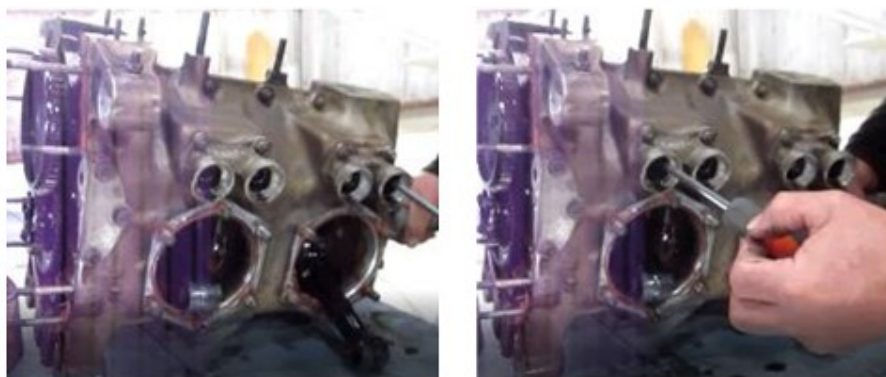
Figura 15 y16. Comprobación de funcionamiento de árbol de levas.
