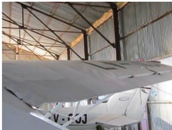
Figura 5. Deformación en el extradós del ala derecha
