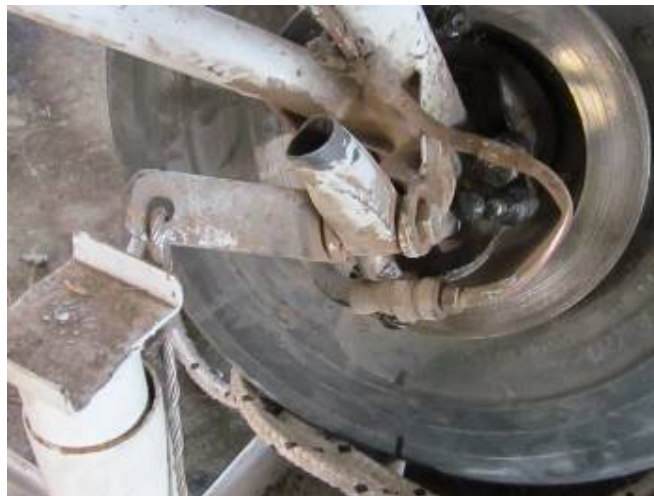
Figura 4. Deformación del disco de freno rueda izquierda
