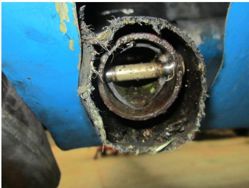
Figura 2. Vista de la fractura del conjunto de tren de nariz
