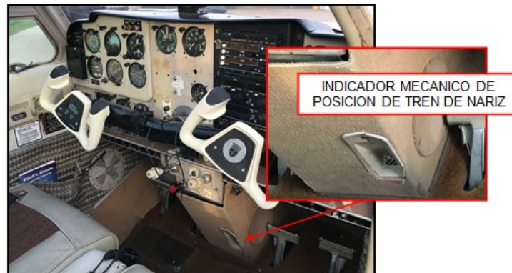
Figura 3. Indicador mecánico de posición de tren de aterrizaje de nariz
