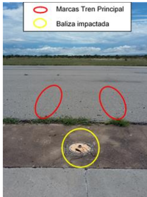
Figura 12. Marcas del toque
