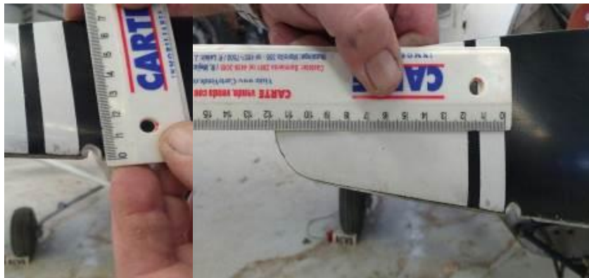
Figura 7. Daños en la hélice
