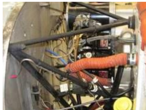
Figura 6. Reticulado de bancadas
