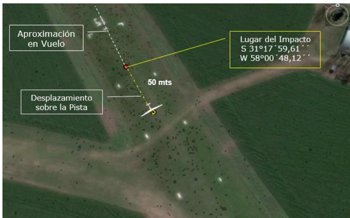
Figura 3. Trayectoria final de la aeronave
