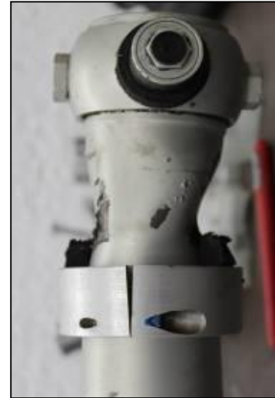
Figura 10. Izquierda: esquema de un mast bumping. Derecha: daños del mástil del rotor principal
