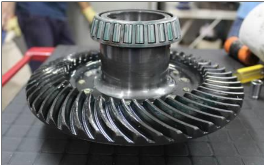
Figura 88. Detalle del engranaje de la caja de transmisión.
