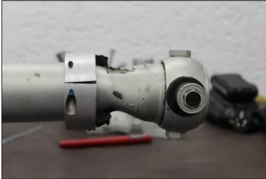
Figura 19. Daños en el extremo del mástil.
