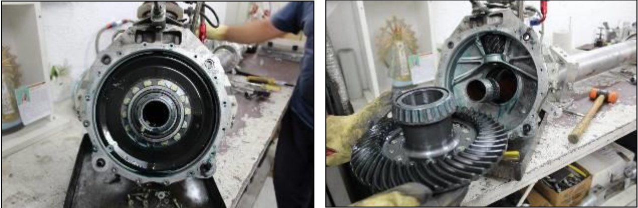
Figura 77. Vistas del desarme de la caja de transmisión.
