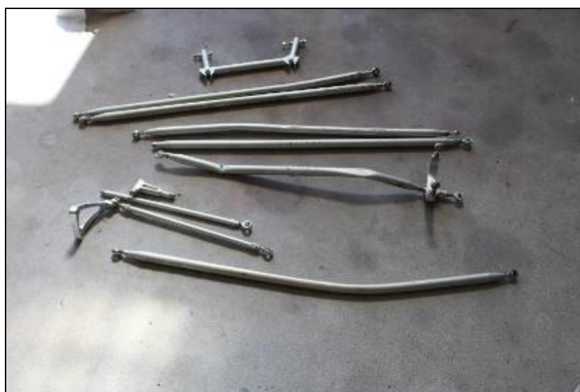
Figura 55. Detalle de las barras retiradas de la aeronave para su análisis pormenorizado
