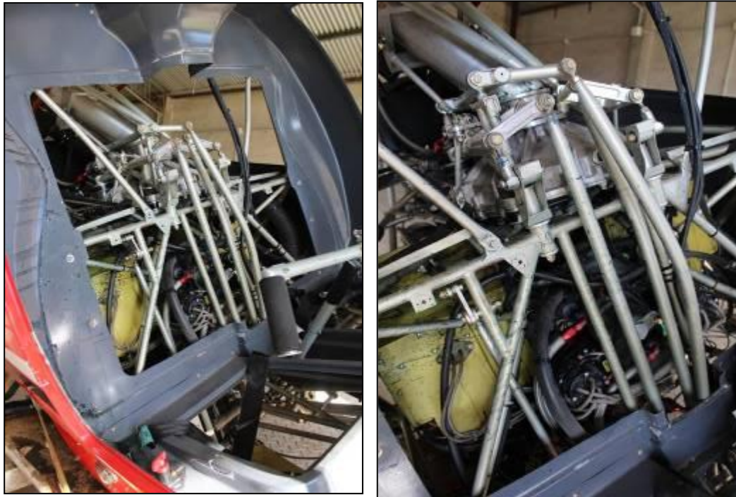
Figura 14. Daños por deformación en las barras de transmisión y detalle de los calafateados en buen estado
