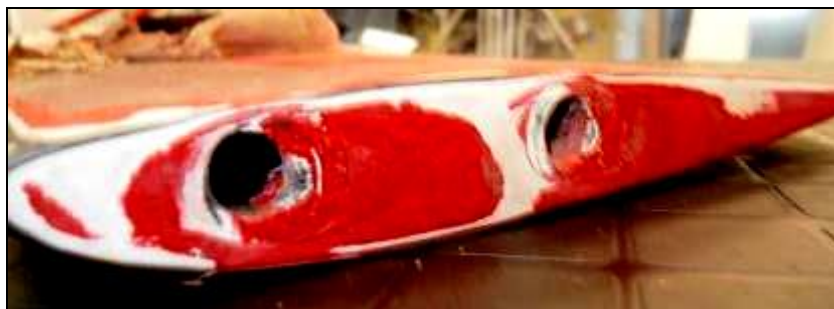
Figura 9. Perfil de puntera con los contenedores de contrapeso abiertos
