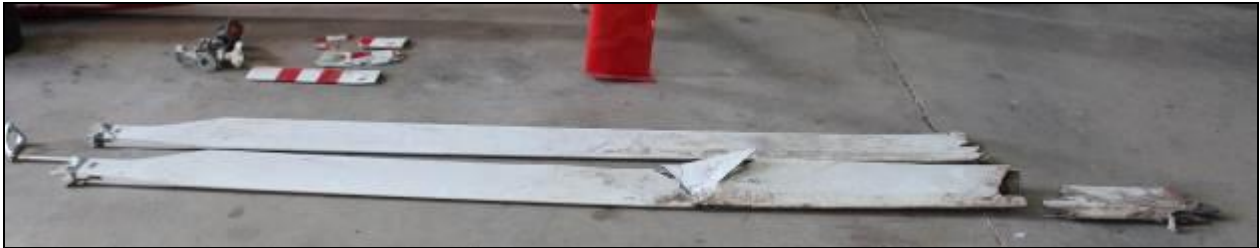
Figura 7. Restos de las palas del rotor principal y de cola
