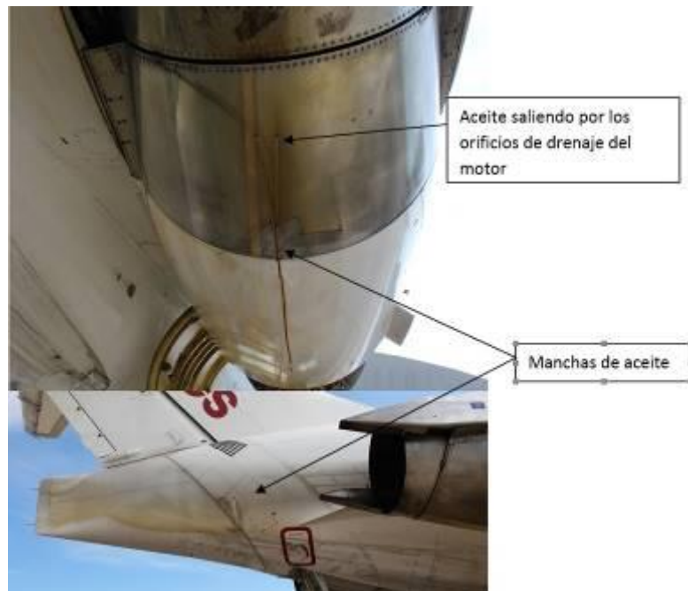
Figura 7. Pérdida de aceite
