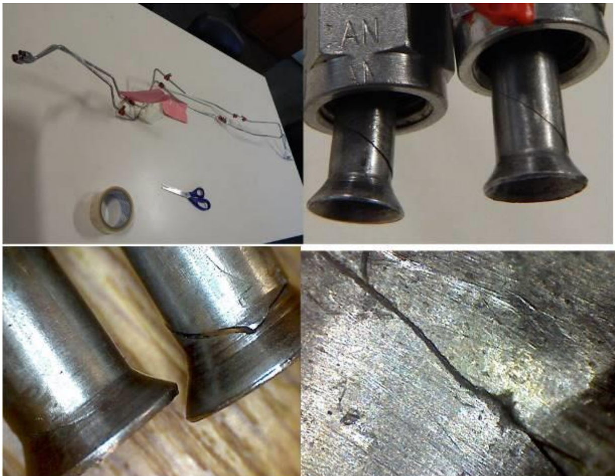
Figura 8. Detalle de los tubos fisurados
