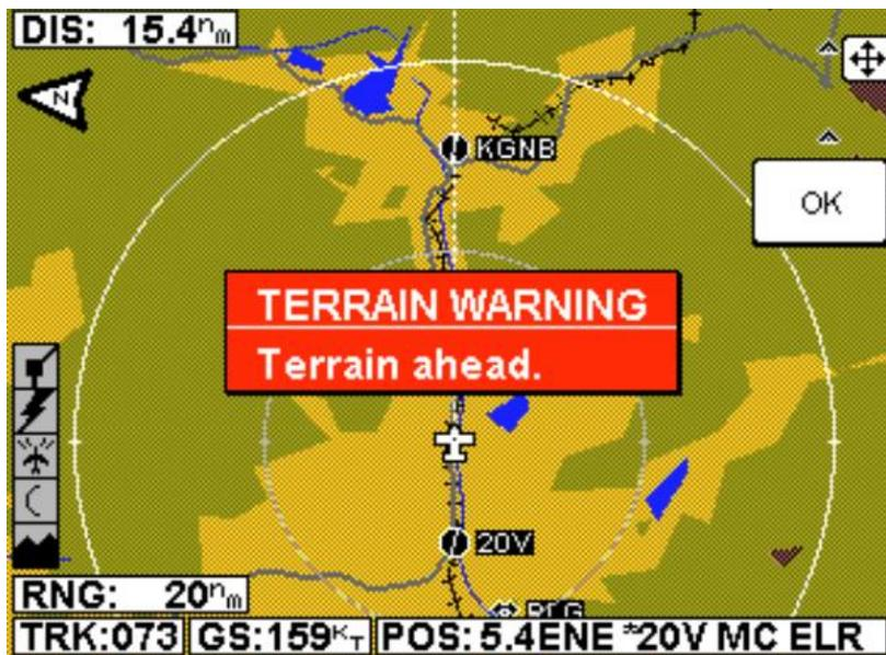
Figura 26. Mensaje terrain warning
