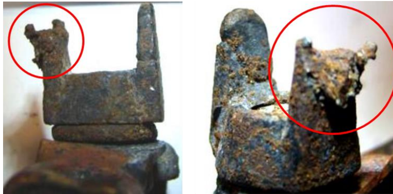
Figura 14. Detalle de la mariposa del conector de la batería
