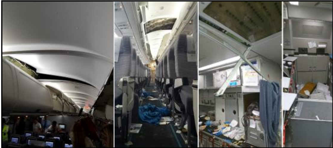
Figura 25. Imagen de los daños en el interior de cabina
