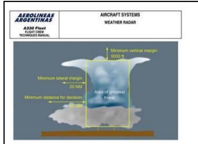
Figura 17. Márgenes laterales y verticales de separación de un núcleo convectivo (FCTM de Aerolíneas Argentinas)
