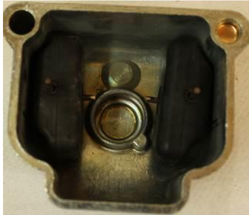
Figura 14. Cuba del carburador izquierdo sin elementos contaminantes
