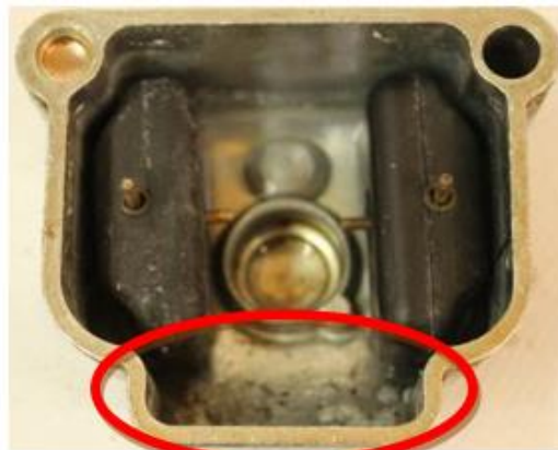
Figura 13. Cuba del carburador derecho con residuos de óxido blanco
