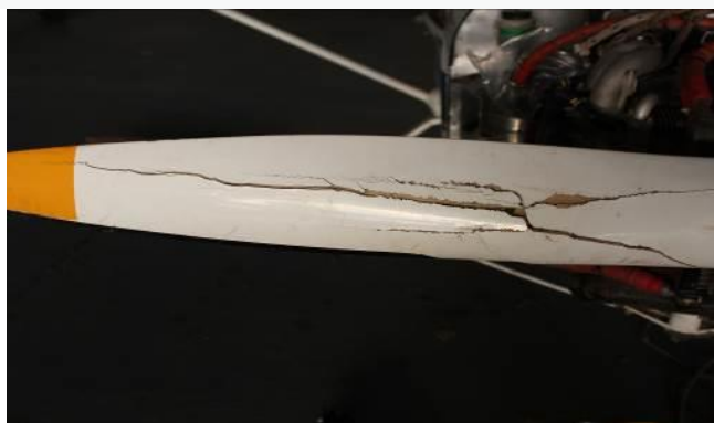
Figura 4. Daños en las hélices
