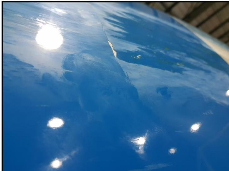
Figura 1. Imagen de los daños en el fuselaje
