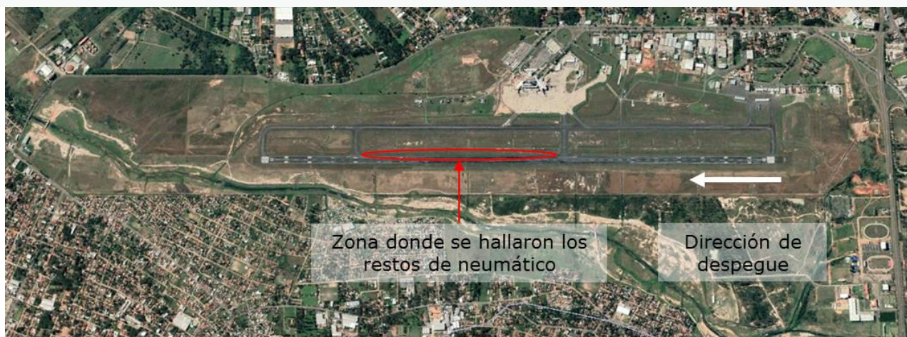
Figura 5. Dispersión de restos del neumático en el Aeropuerto Internacional Silvio Pettirossi
