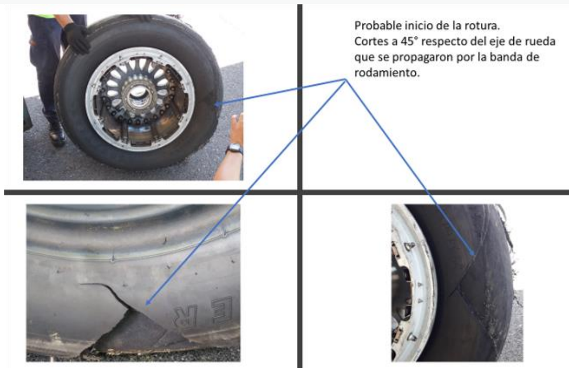
Figura 11. Daños detectados en el neumático
