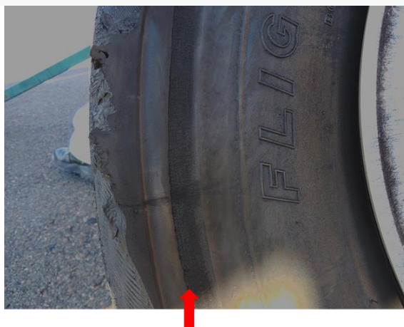
Figura 7. Marcas de recapado
