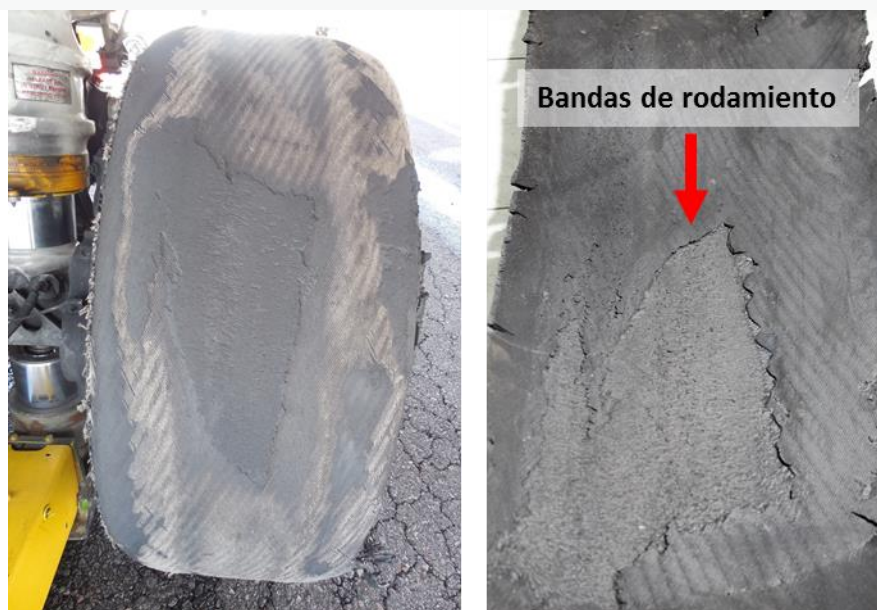
Figura 9. Defectos de repicado
