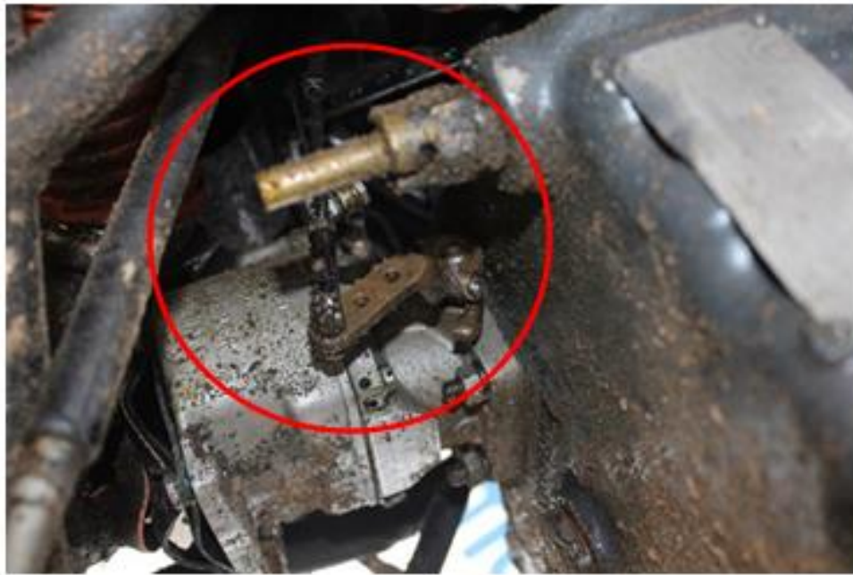
Figura 5. Conexión de comandos del carburador
