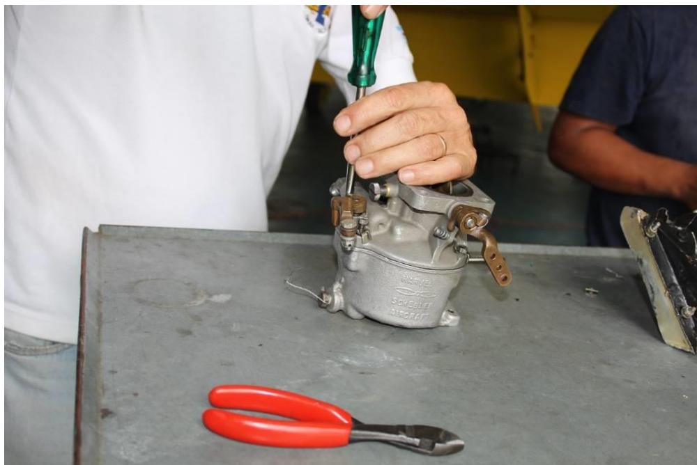
Figura 6. Desarme del carburador
