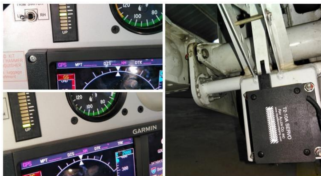
Figura 19. Actuador de trim de profundidad del LV-GKY (derecha) instalado en la aeronave LV-GUX e indicación de las diferentes posiciones observadas (izquierda). Fuente: investigación JST
