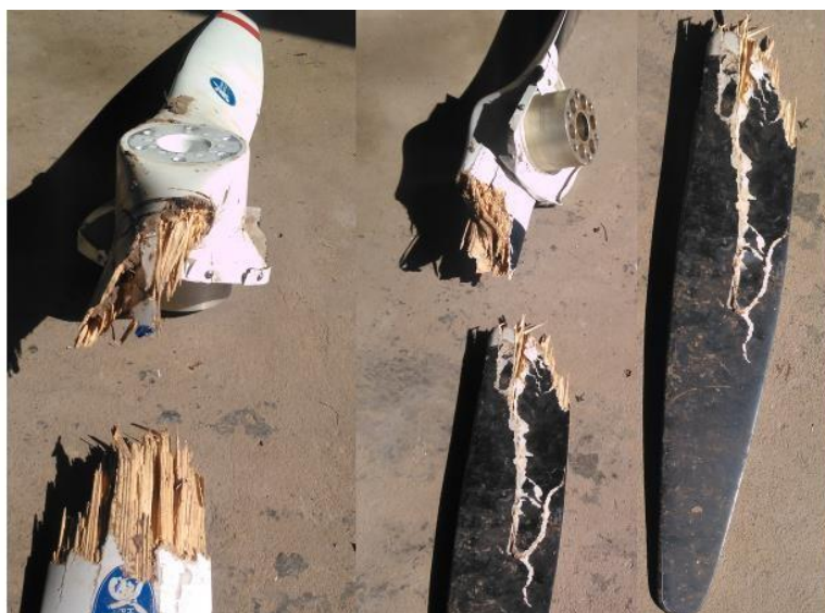
Figura 3. Daños en la hélice. Fuente: investigación JST
