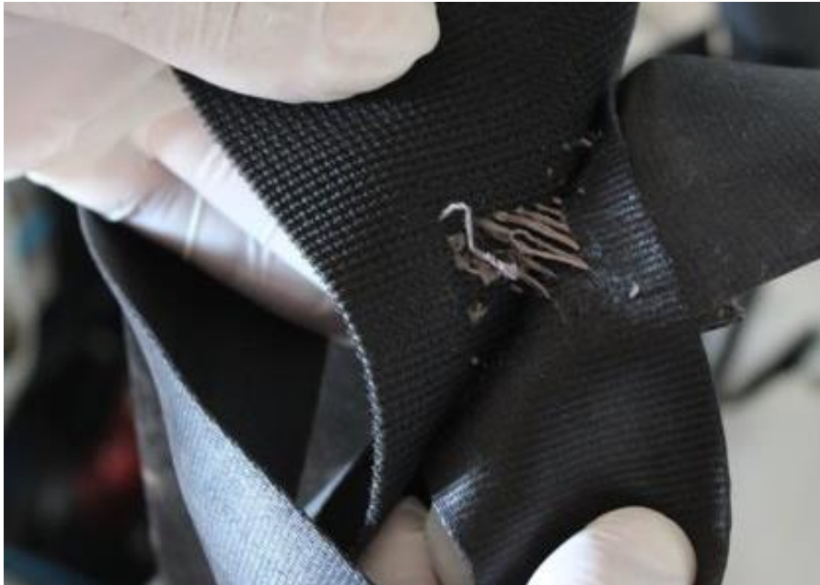
Figura 7. Fallas detectadas en el cinturón de seguridad del puesto izquierdo. Fuente: investigación JST
