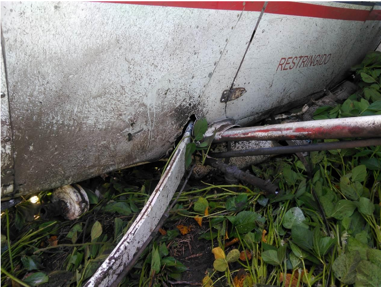
Figura 4. Daños recibidos por la aeronave
