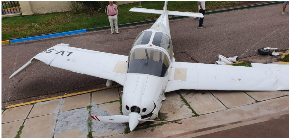
Figura 2. Daños en la célula
