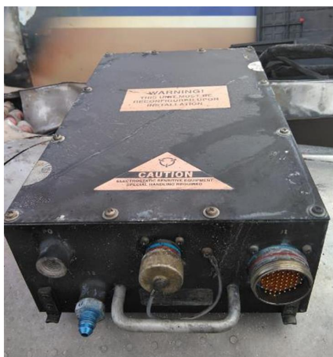
Figura 12. Imagen de una DEEC recuperada. Fuente: investigación JST
