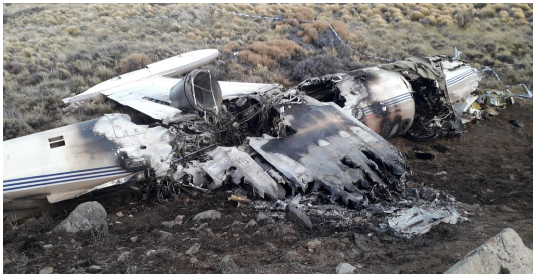
Figura 19. Restos de la aeronave tras el incendio. Fuente: investigación JST
