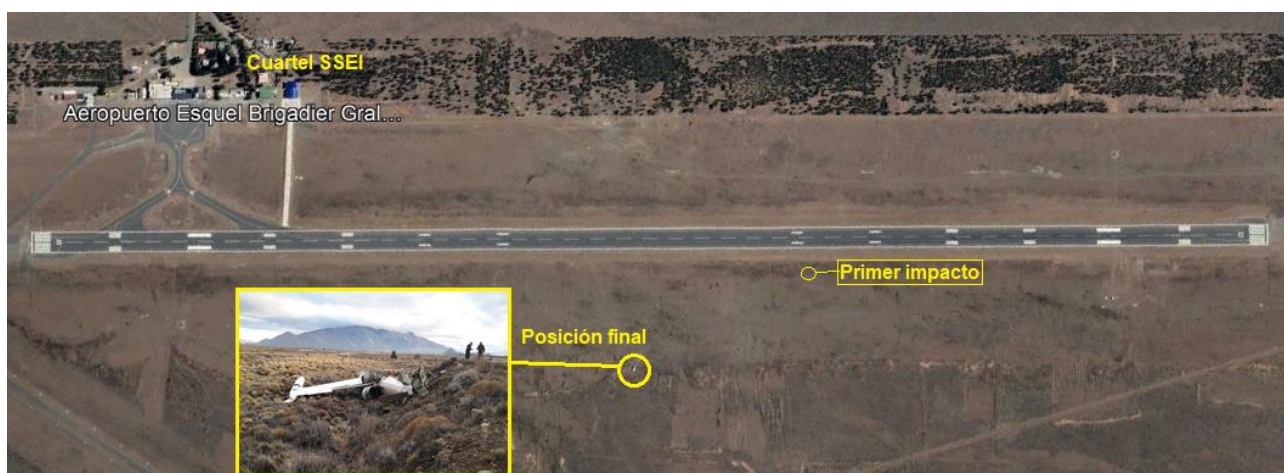
Figura 15. Primer impacto y posición final en relación con la pista 23. Fuente: investigación JST
