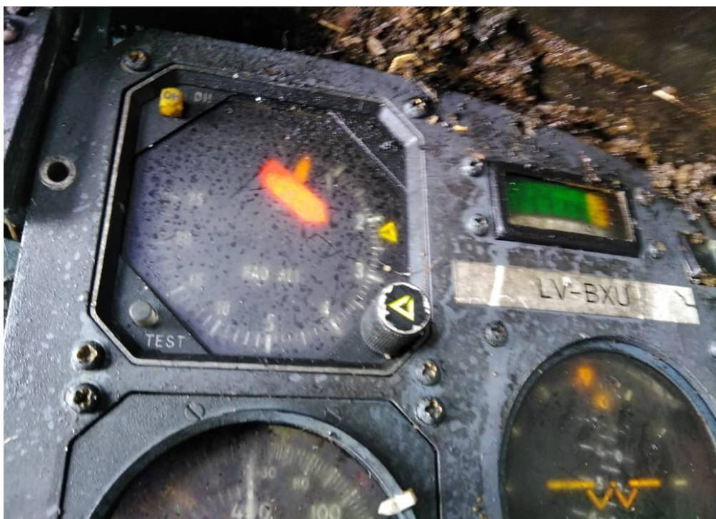
Figura 29. Radio altímetro del LV-BXU. Fuente: investigación JST
