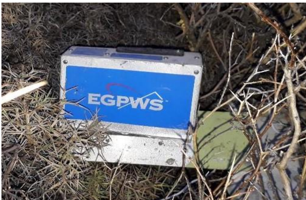
Figura 14. Imagen del EGPWS. Fuente: investigación JST
