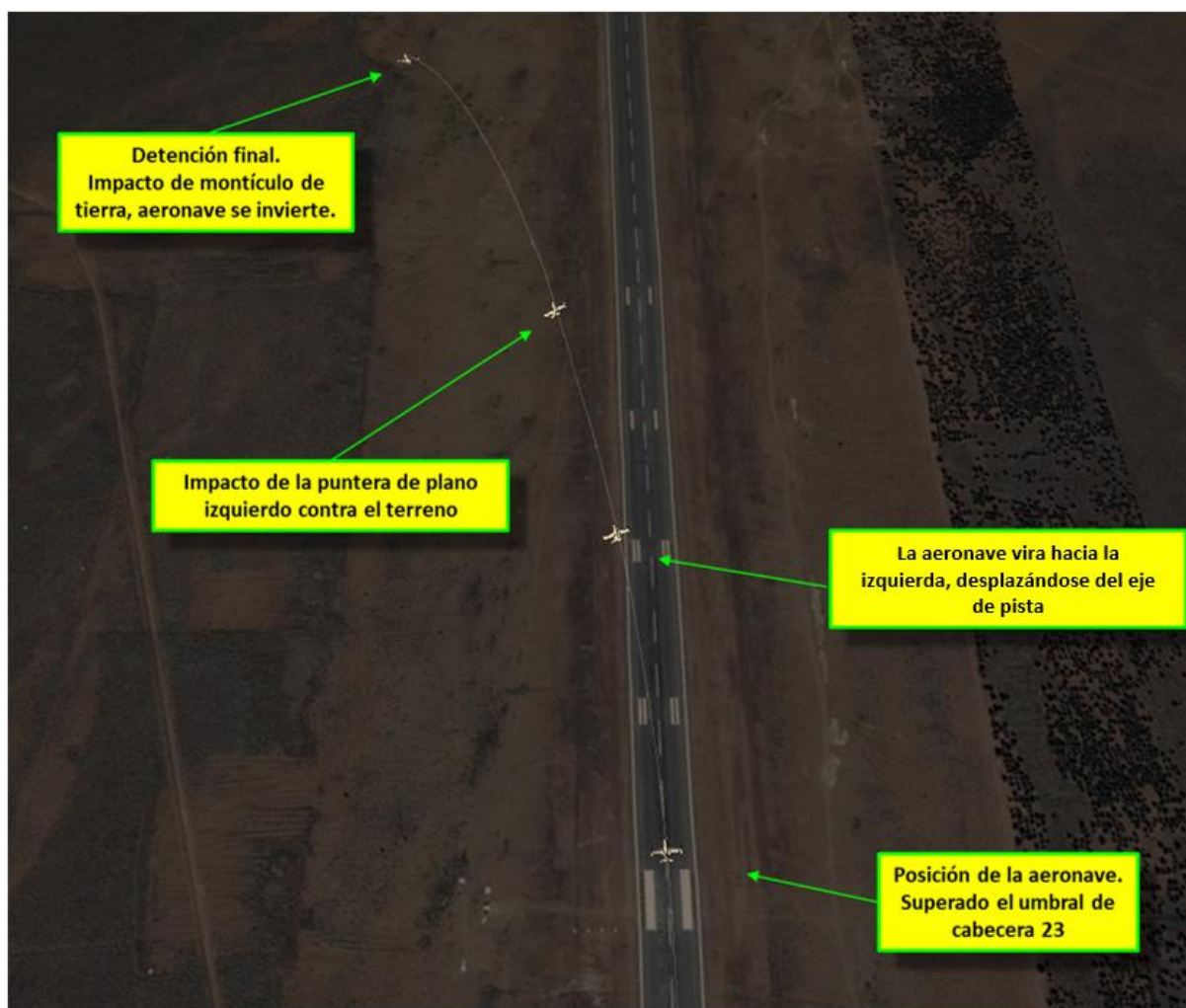
Figura 17. Simulación de la trayectoria de la aeronave. Fuente: investigación JST
