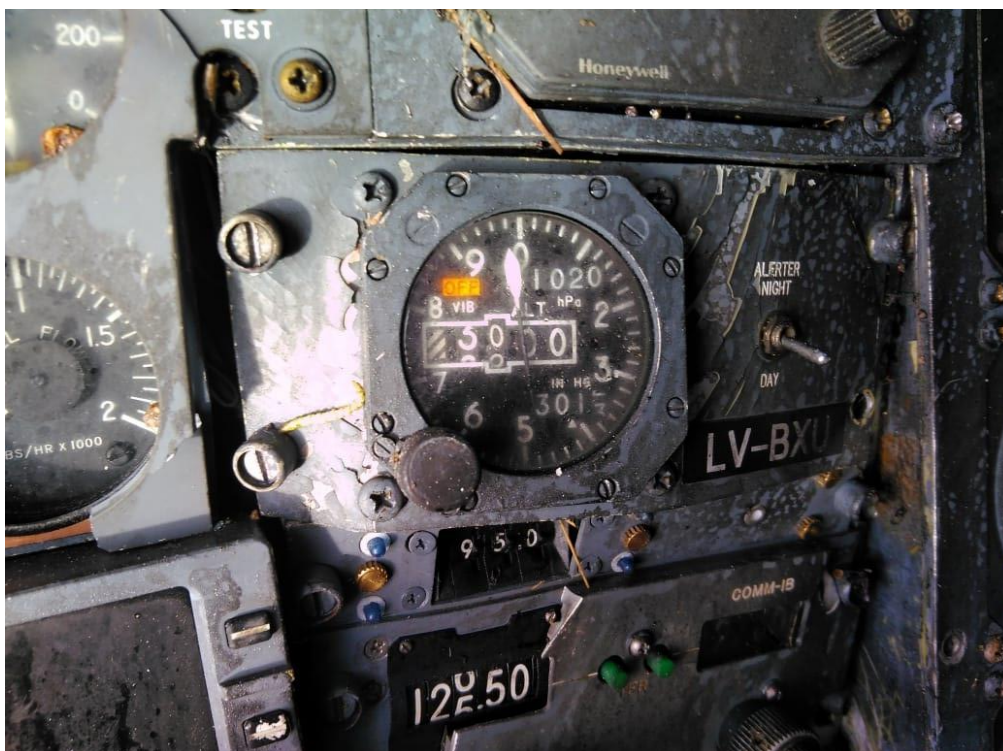
Figura 28. Altimetro standby del LV-BXU. Fuente: investigación JST
