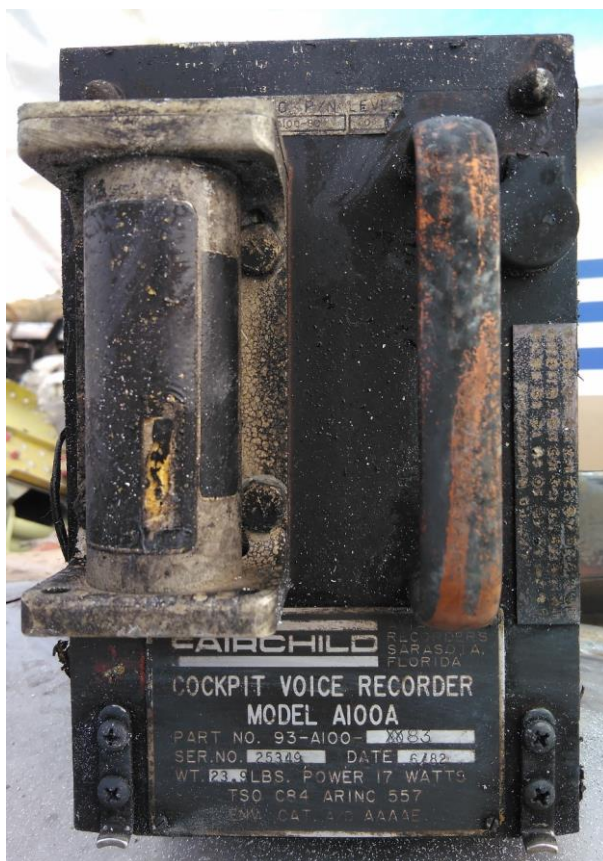
Figura 11. Imagen del CVR recuperado. Fuente: investigación JST
