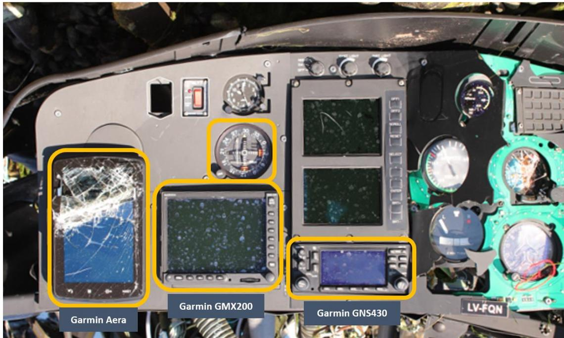
Figura 16. Panel de instrumentos. Fuente: investigación JST
