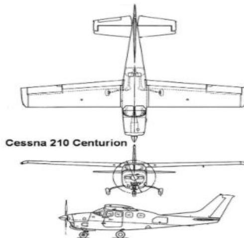
Figura 5. Perfil de la aeronave
