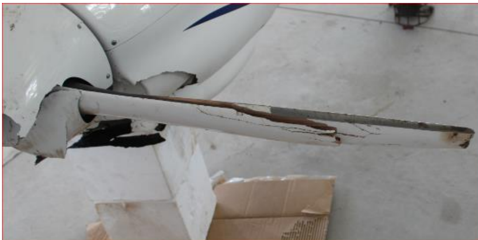
Figura 5. Daños en la hélice y el cono
