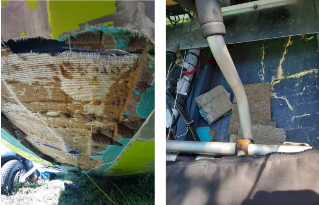
Figura 3. Rotura en la zona ventral del fuselaje
