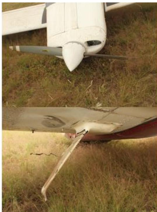
Figura 1. Imágenes de daños en la aeronave
