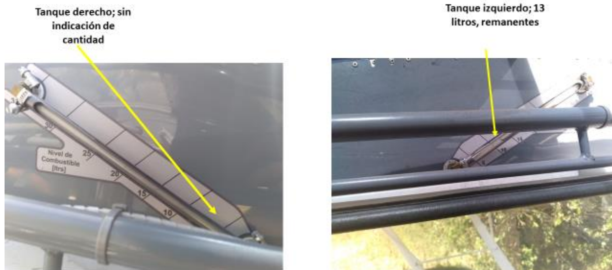
Figura 2. Imagen de los indicadores de combustible luego del aterrizaje de emergencia. Fuente: investigación JST
