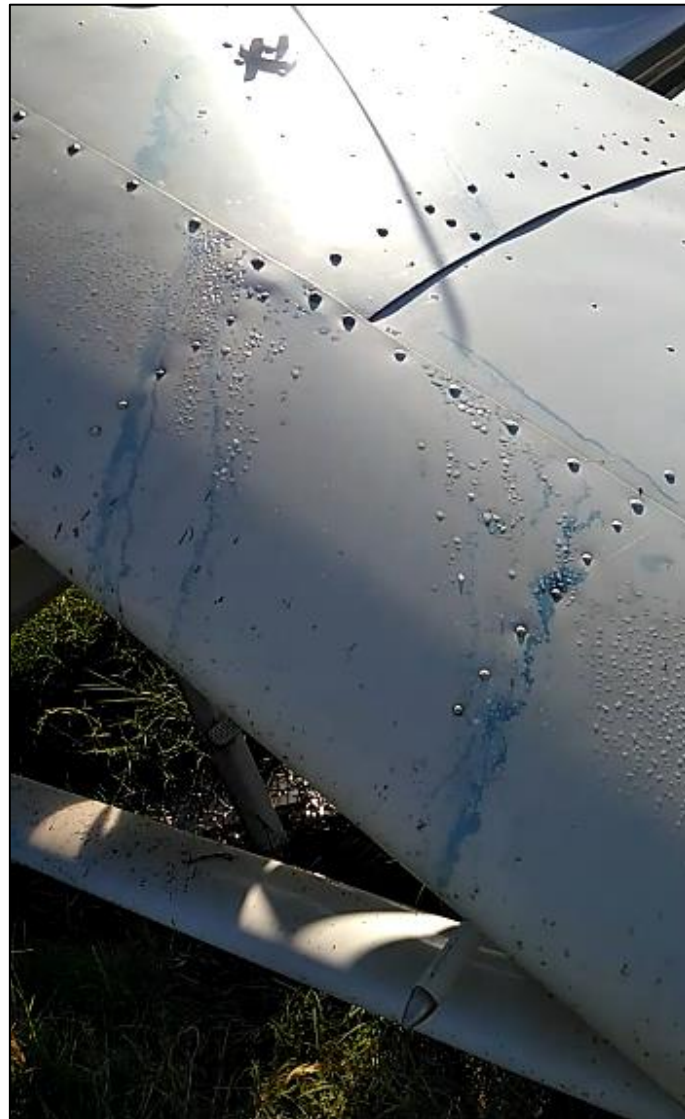
Figura 3. Pérdida de combustible posterior al impacto. Fuente: investigación JST
