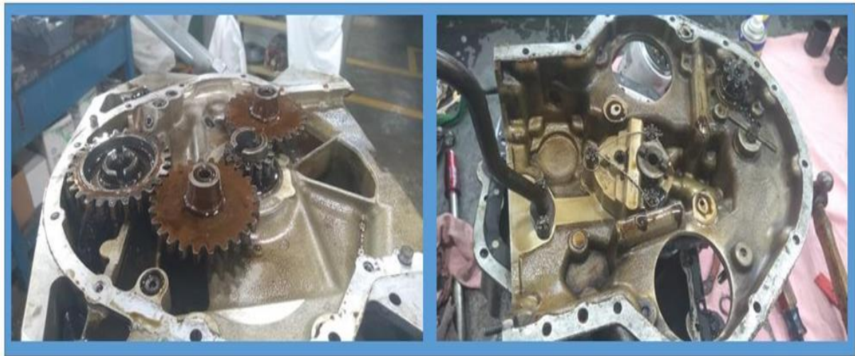
Figura 7. Desmontaje de engranajes/caja de mecanismos. Fuente: investigación JST
