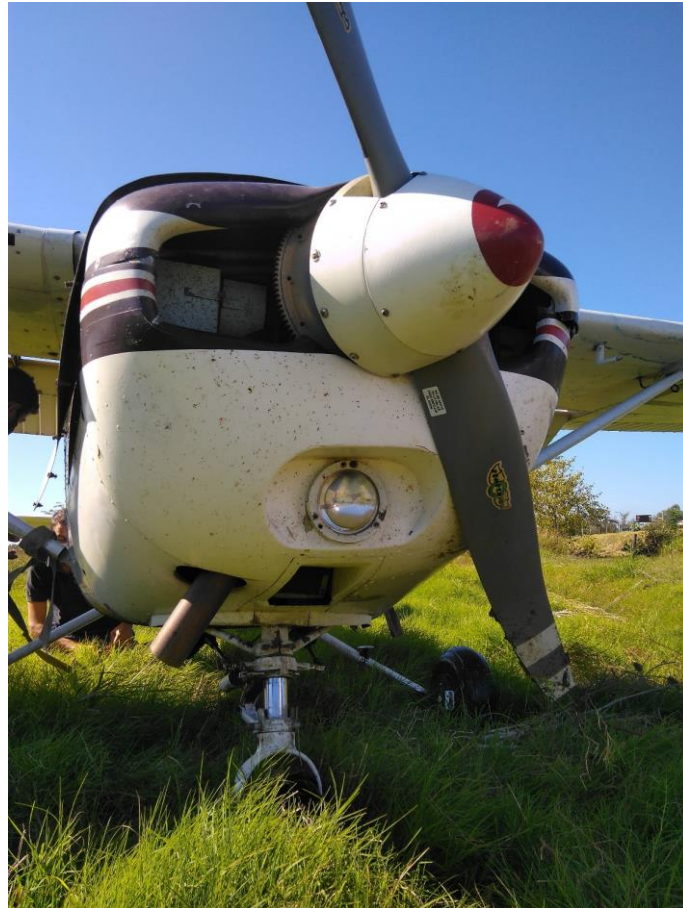
Figura 2. Daños en hélice. Fuente: investigación JST
