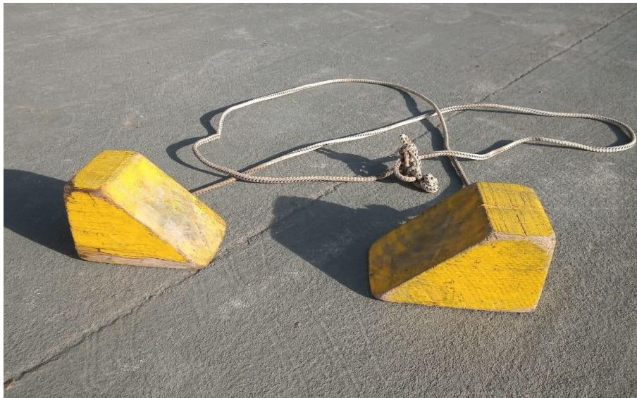
Figura 3. Calzas utilizadas para la puesta en marcha del LV-YQF
