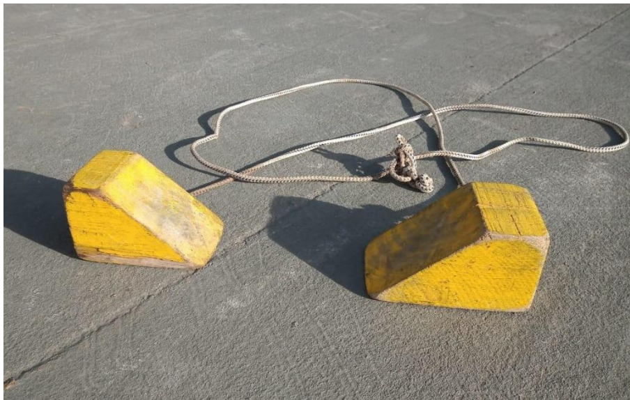
Figura 2. Calzas utilizadas para la puesta en marcha del LV-YQF
