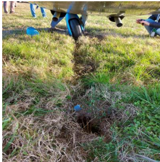
Figura 11 Rejilla y Trayectoria de detención colapso tren de nariz
