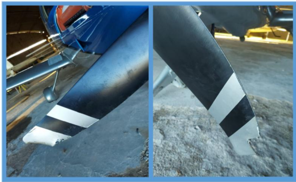
Figura 3 – Daños en las Palas
