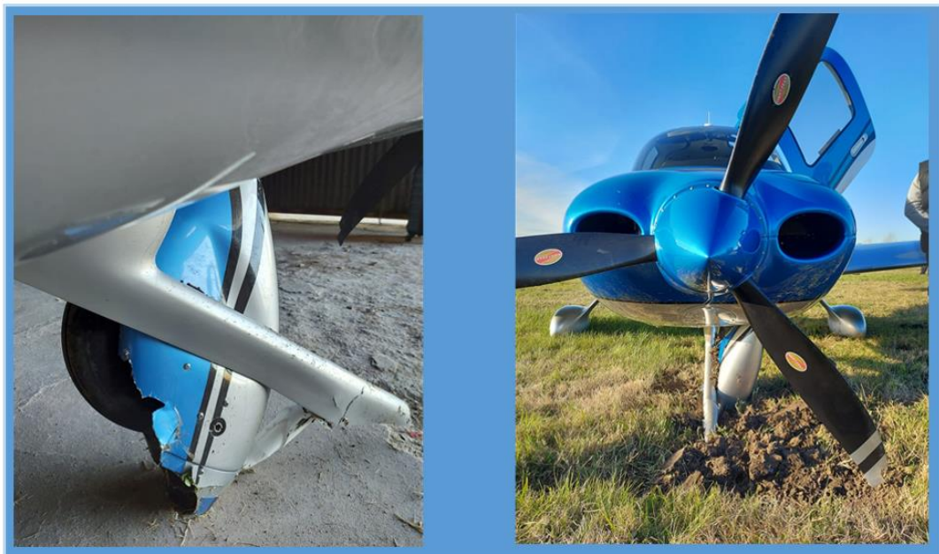
Figura 2 Daños en Célula
