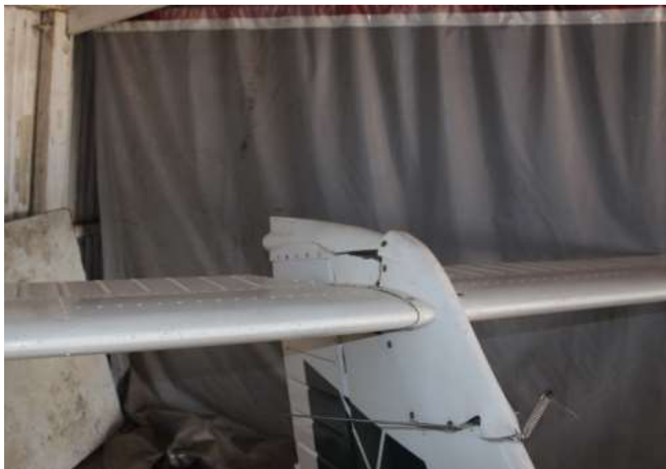
Figura 4. Daños en el empenaje vertical
