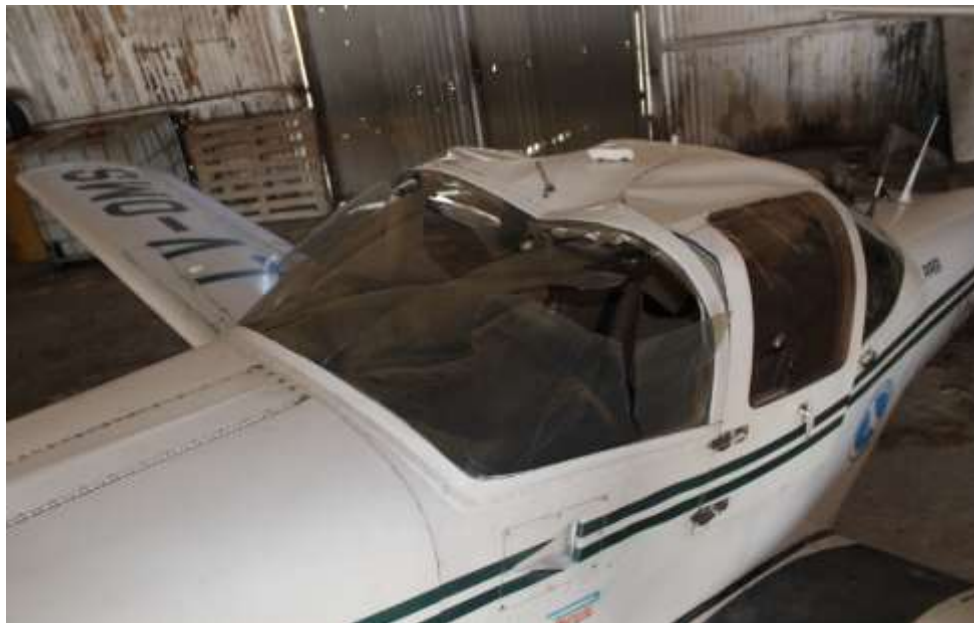
Figura 2. Daños en la parte superior de la cabina
