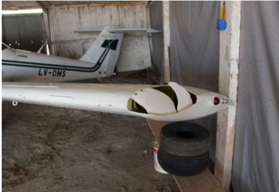
Figura 3. Daños en la puntera izquierda de ala
