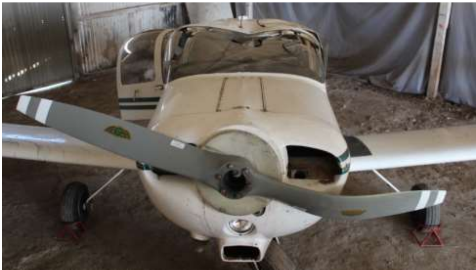
Figura 7. Deformación en una de las palas de la hélice
