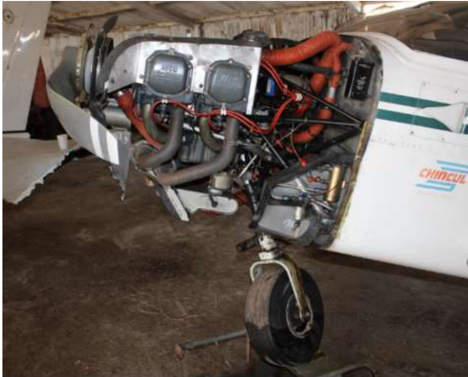
Figura 5. Vista lateral izquierdo de los daños en tren de nariz
