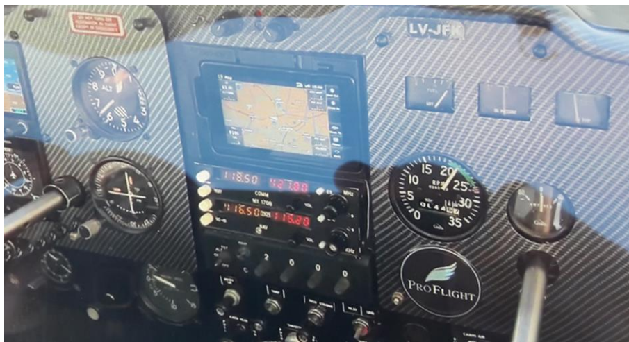
Figura 10. Equipo GPS instalado en la aeronave. Fuente: investigación JST
