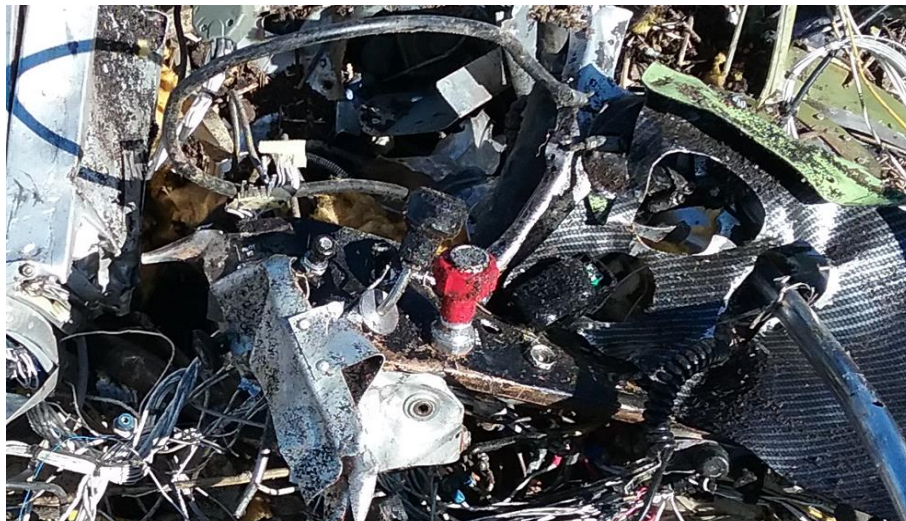
Figura 13. Posición de los comandos de acelerador y mezcla de la aeronave. Fuente: investigación
