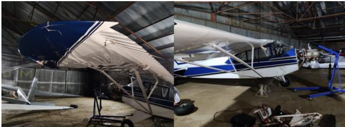
Figura 2. Imagen de los daños en la aeronave
