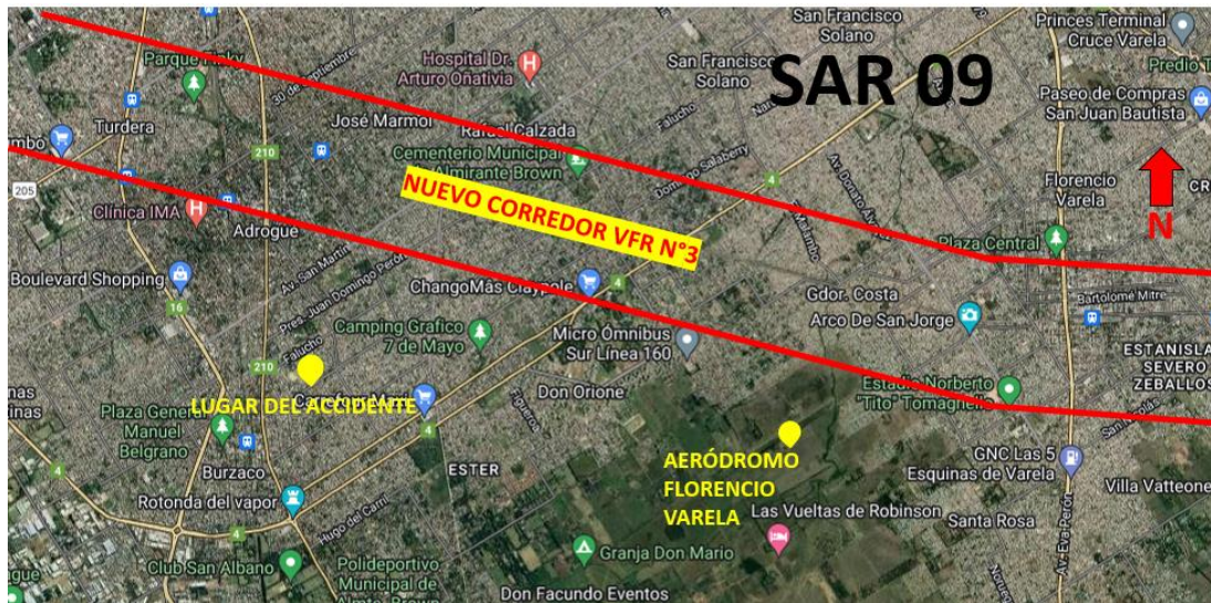
Figura 8. Corredor VFR N°3 luego de la modificación de la AIP. Fuente: investigación JST
