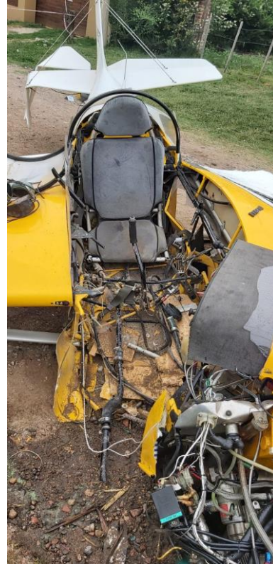
Figura 9. Tablero separado de la cabina
