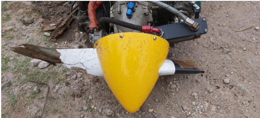
Figura 4. Daños en la hélice
