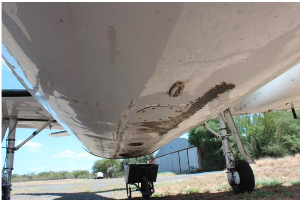
Figura 2. Raspaduras en la parte inferior del fuselaje
