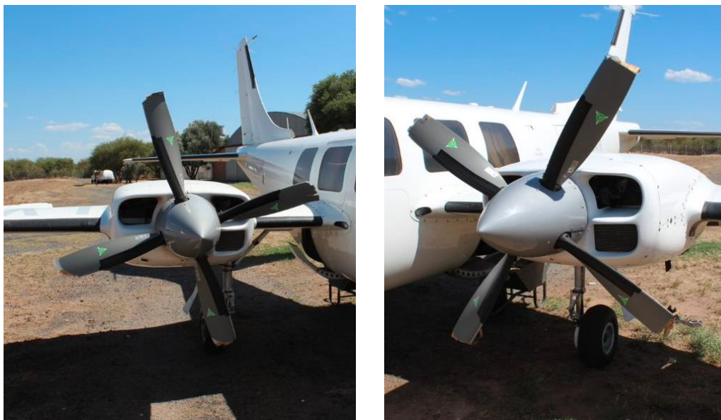
Figura 4. Vista general de las palas destruidas
