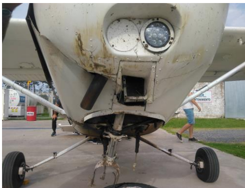
Figura 1. Daños en carenado de motor y tren de nariz.
