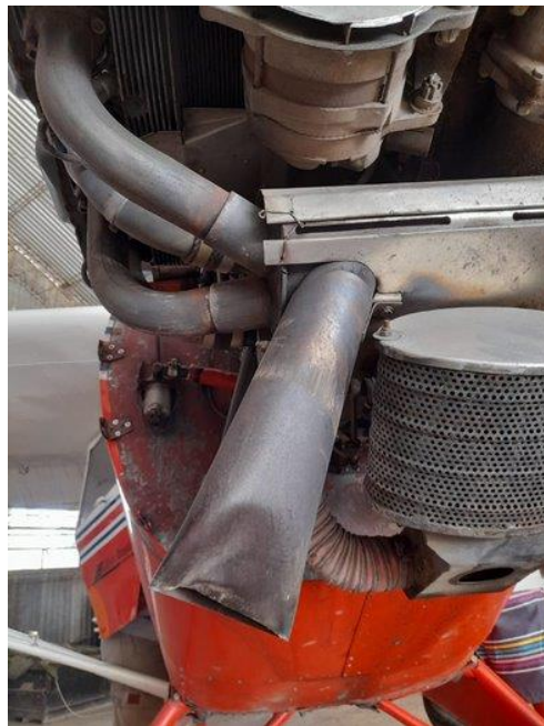
Figura 6. Caño de escape con deformaciones
