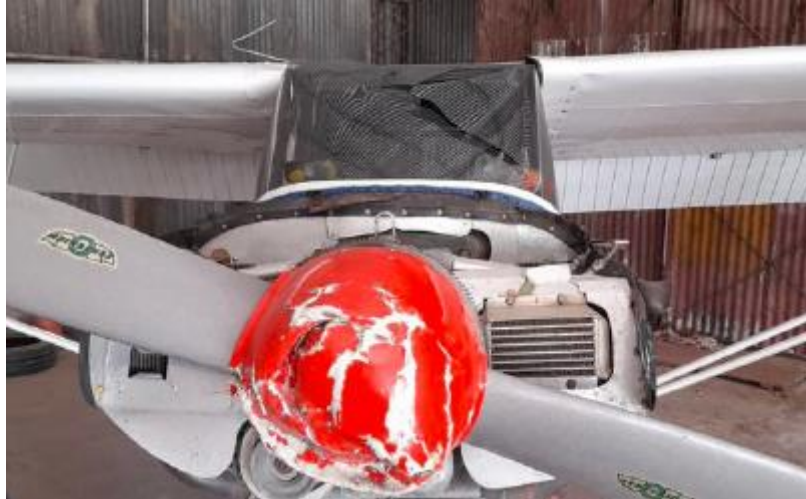
Figura 5. Daños en el parabrisas
