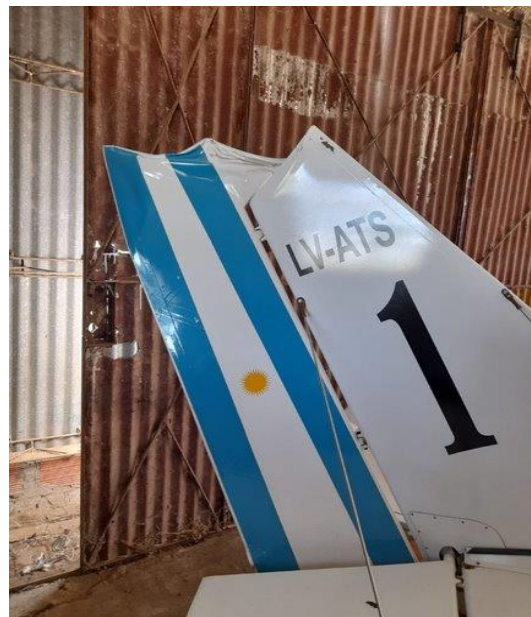
Figura 2. Estabilizador y timón de dirección con deformaciones
