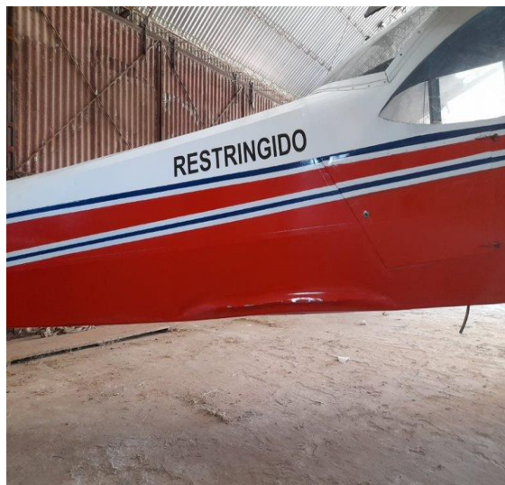
Figura 3. Daños en el fuselaje
