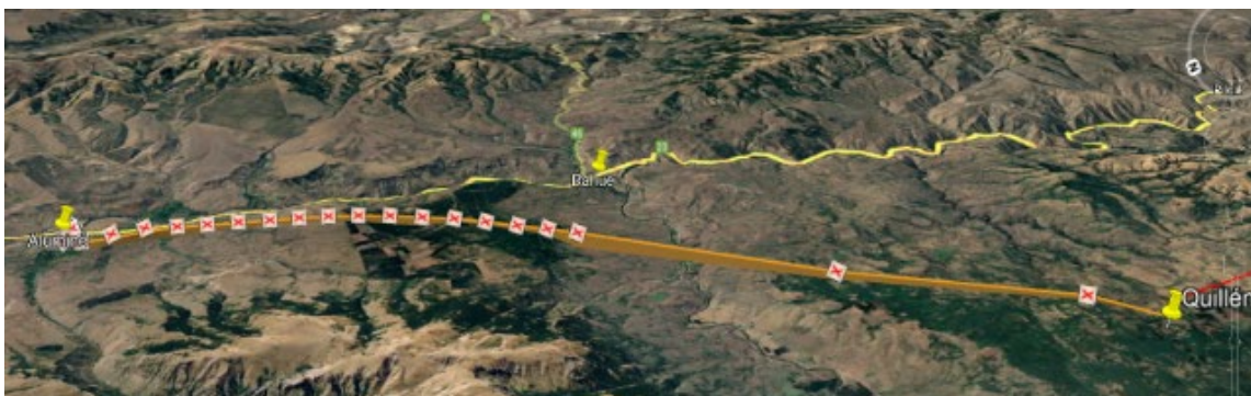
Figura 15. Información proporcionada por el sistema de seguimiento satelital. Cada X es un pulso que registra velocidad, altura, rumbo, coordenadas y hora entre otros. Fuente: investigación JST
