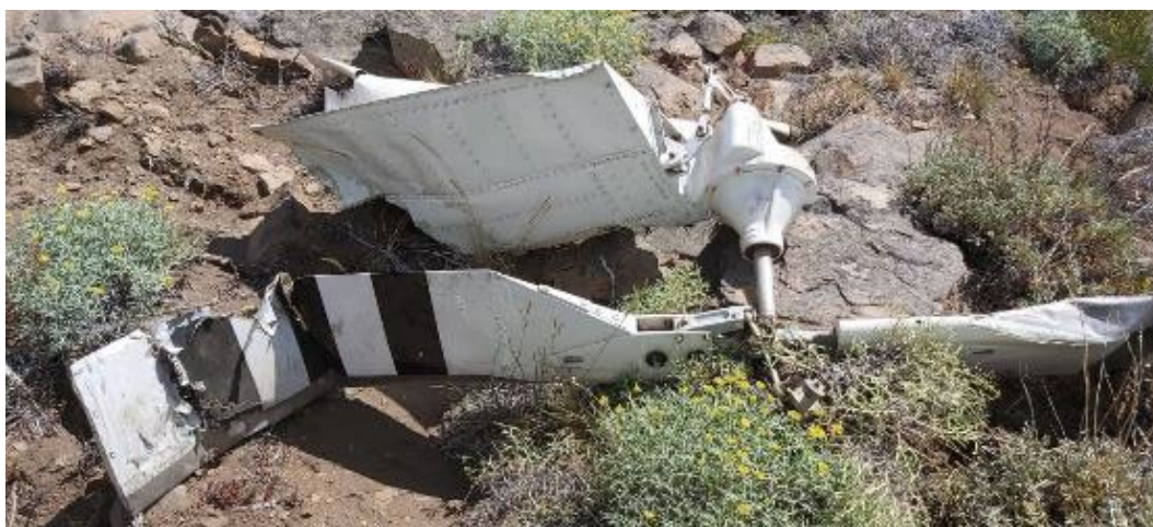
Figura 5. Daños en el rotor de cola. Fuente: investigación JST
