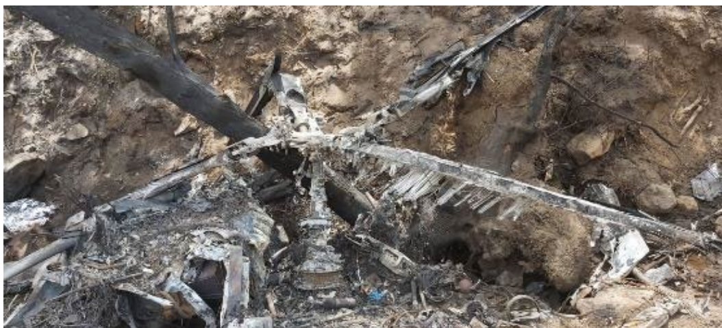
Figura 4. Estado del rotor principal. Fuente: investigación JST
