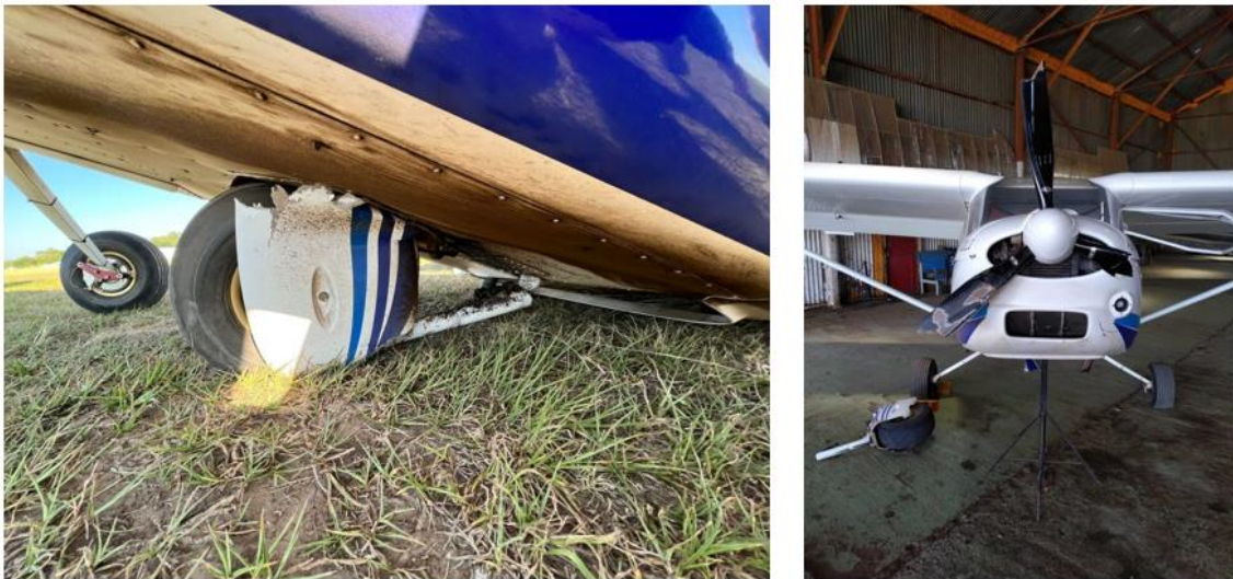
Figura 2. Daños en el tren de nariz, zona inferior del fuselaje u hélice. Fuente: investigación JST
