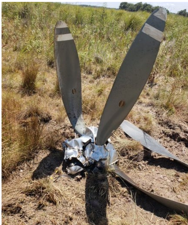
Figura 3. Daños de la hélice del LV-WZE. Fuente: investigación JST
