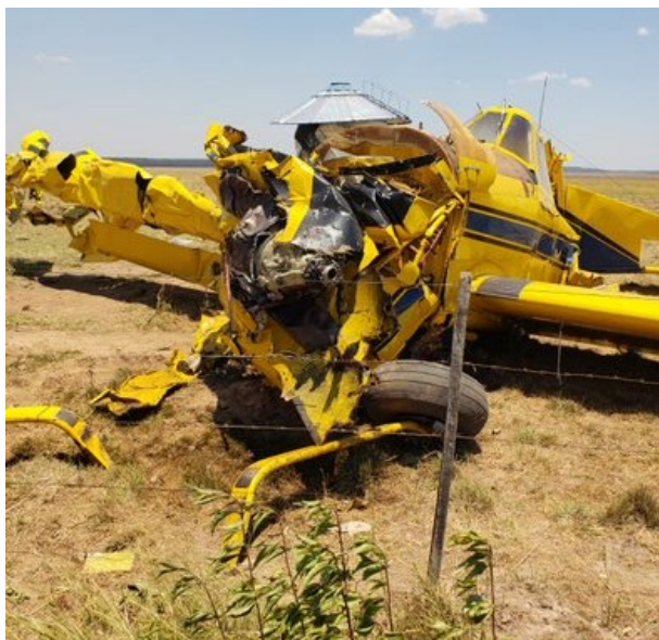
Figura 2. Daños del motor del LV-WZE. Fuente: investigación JST
