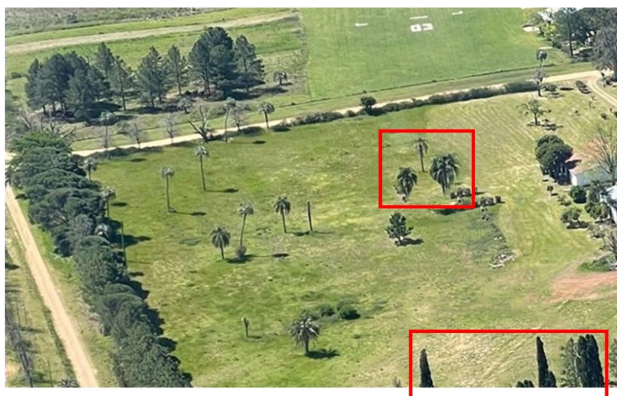
Figura 3. Presencia de árboles en la aproximación de la pista 03. Fuente: investigación JST
