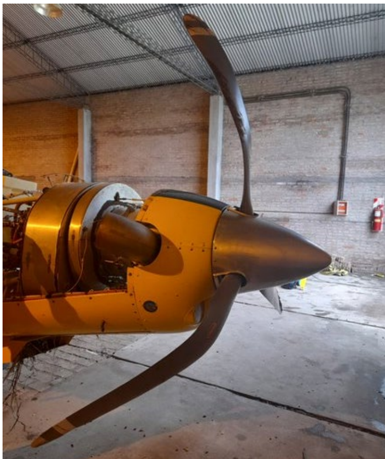
Figura 3. Daños en las palas del conjunto de hélice. Fuente: investigación JST
