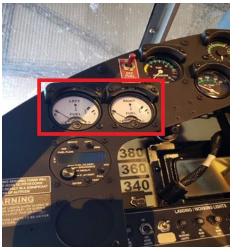
Figura 6. Indicadores de cantidad de combustible por ala. Fuente: investigación JST
