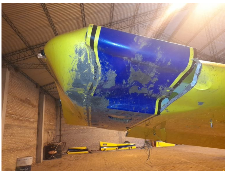
Figura 4. Daños en la puntera del ala derecha. Fuente: investigación JST
