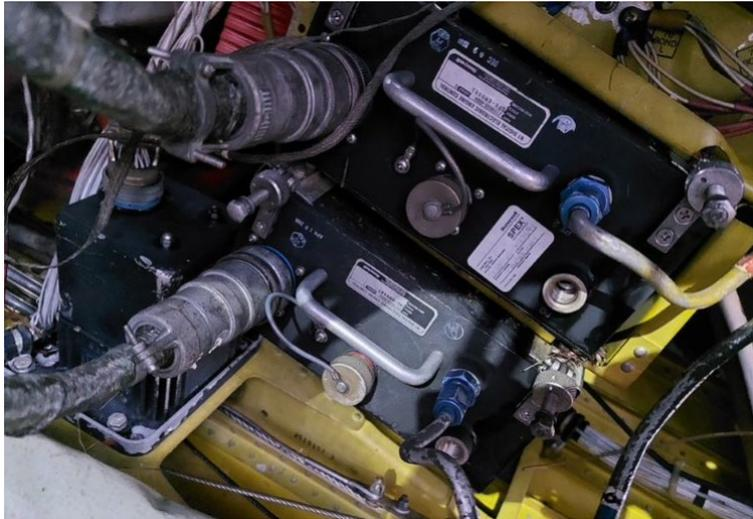
Figura 16. DEEC #1 y DEEC #2 recuperados entre los restos de la aeronave. Fuente: investigación JST
