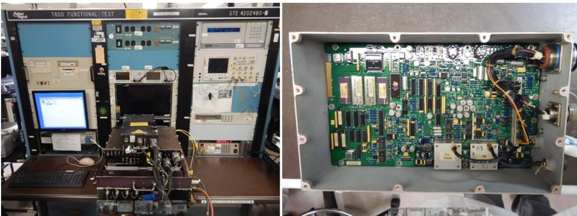
Figura 17. Proceso de extracción de datos de las DEEC. Fuente: informe de *Honeywell Aerospace*
