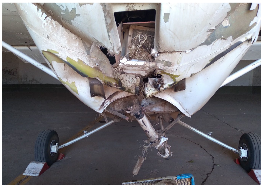
Figura 3. Vista de los daños en el tren de aterrizaje de nariz. Fuente: investigación JST
