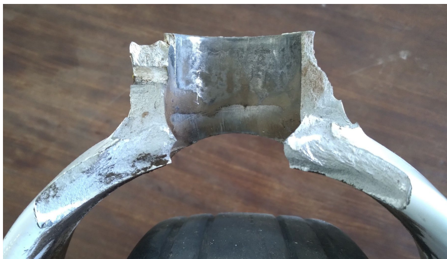
Figura 4. Daños en horquilla de tren de nariz. Fuente: investigación JST
