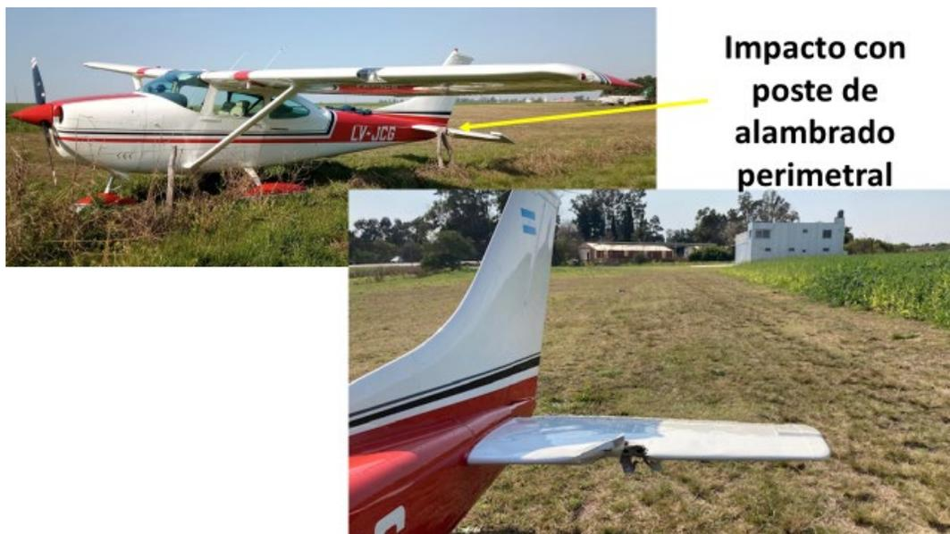
Figura 1. Daños en la aeronave LV-JCG. Fuente: investigación JST
