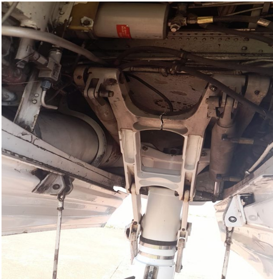
Figura 5. Rotura en el tren de aterrizaje principal izquierdo. Fuente: investigación JST
