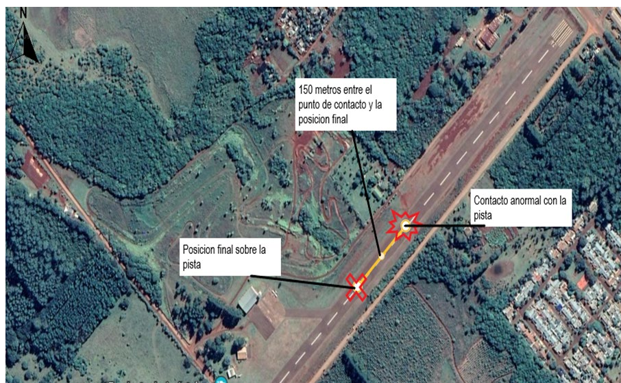
Figura 2. Trayectoria de la aeronave en la pista. Fuente: investigación JST
