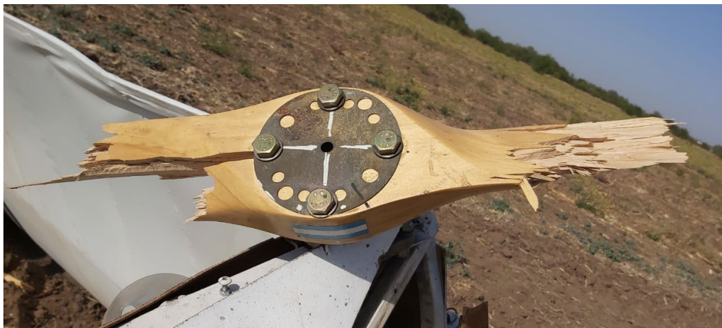
Figura 5. Daños en la hélice. Fuente: investigación JST
