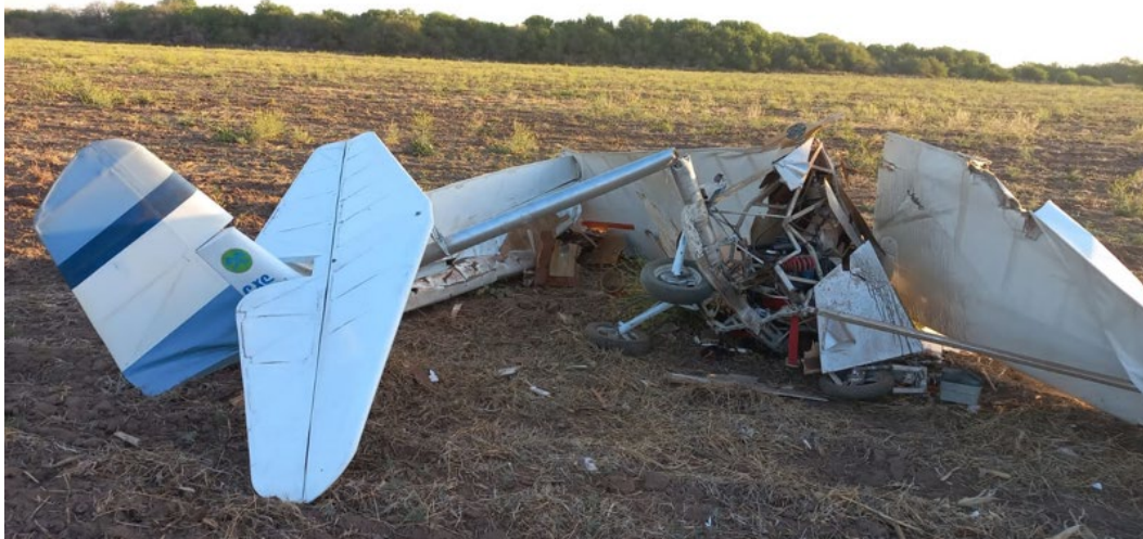
Figura 3. Daños en la célula. Fuente: investigación JST
