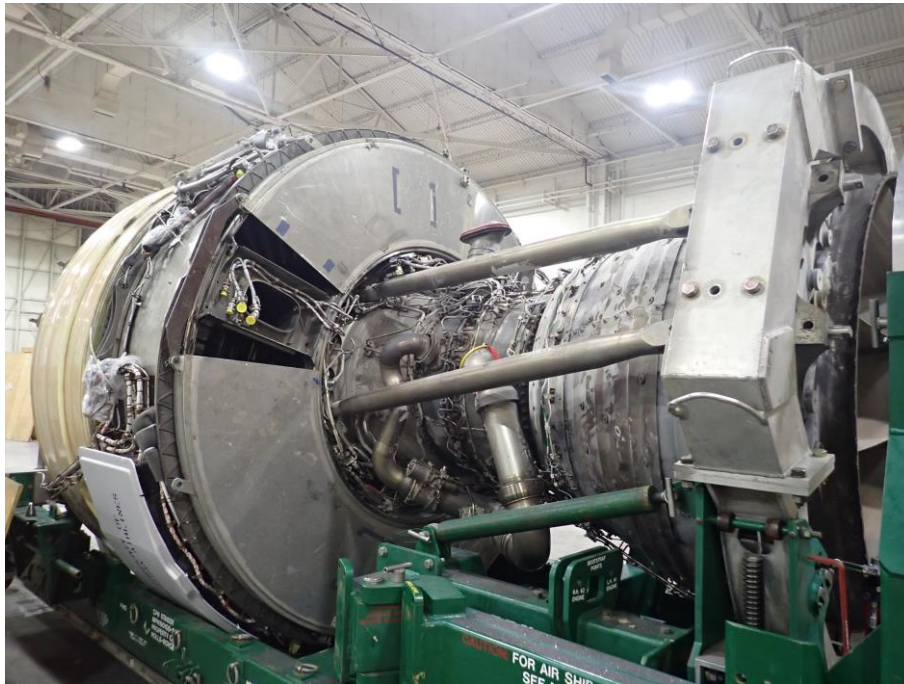
Figura 2. Motor preservado previo a su inspección. Fuente: reporte Rolls Royce
