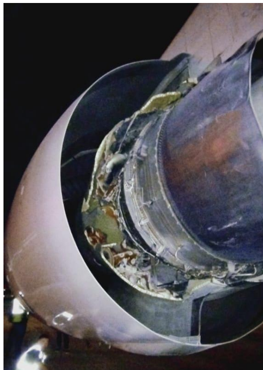
Figura 1. Vista de la zona de escape de by-pass y tobera afectados. Fuente: investigación JST
