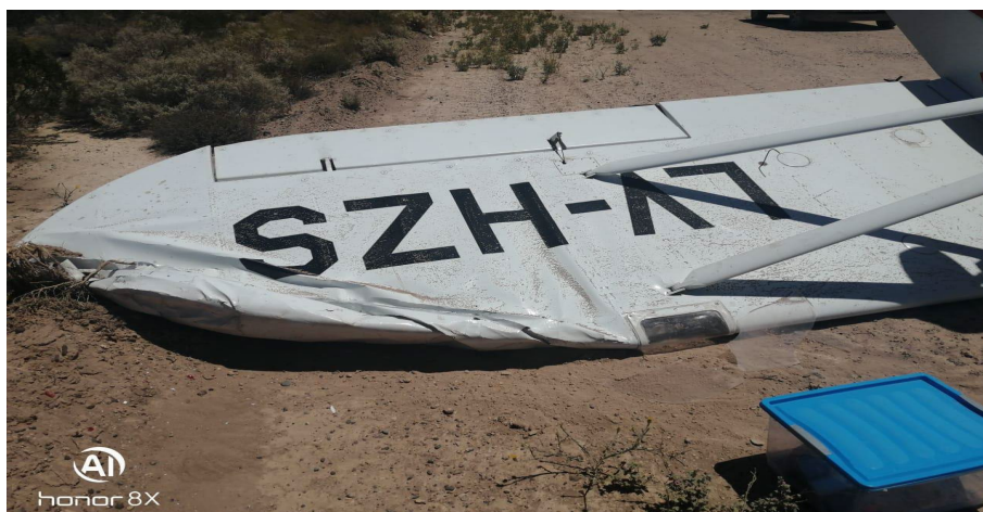
Figura 2. Daños en la puntera y plano izquierdo. Fuente: investigación JST
