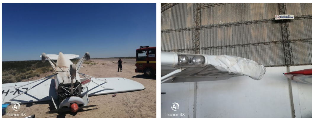
Figura 7. Vista de la aeronave capotada y daños en la puntera de plano izquierdo. Fuente: investigación JST
